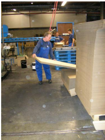
Figuur 7: Overtillen stapels karton bij invoer machine, waarbij soms ook een gedraaide houding voorkomt
