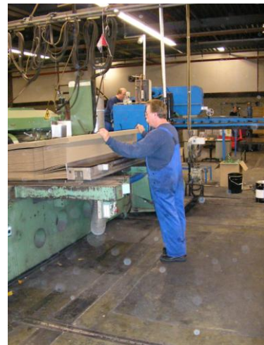
Figuur 7: Overtillen stapels karton bij invoer machine, waarbij soms ook een gedraaide houding voorkomt
