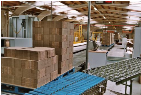
Figuur 17: verschillende soorten rollerbanen
