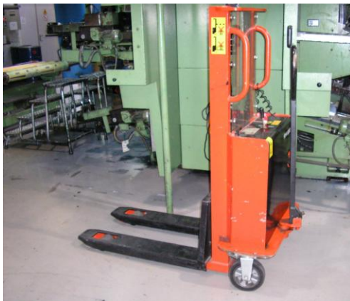
Figuur 25 Elektrische pompwagen
