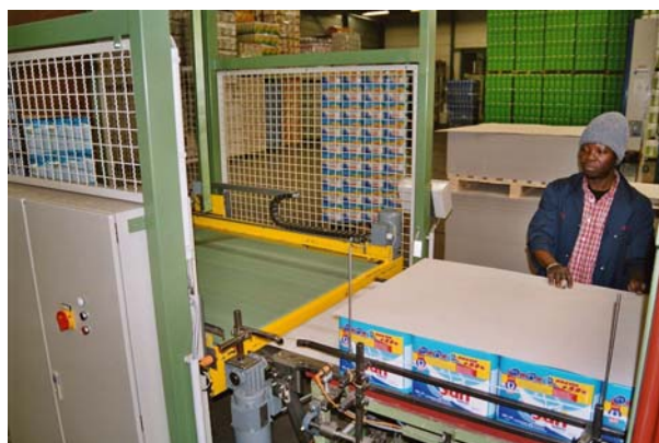
Figuur 9 Stapelaar die steeds op dezelfde hoogte blijft
